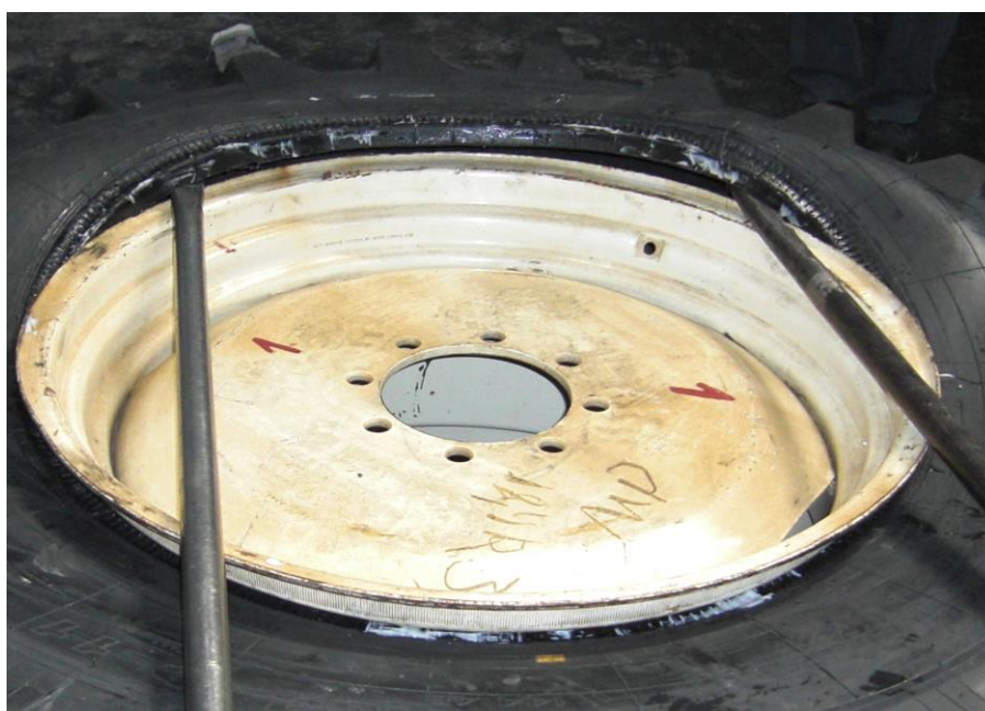
Рис. 19 Извлечение части борта шины за закраину обода.
