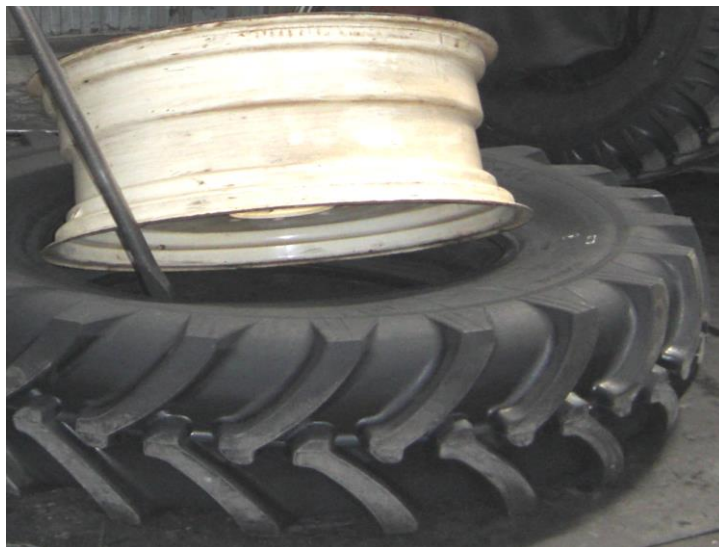
Рис. 9 Начало вставки обода в покрышку.
