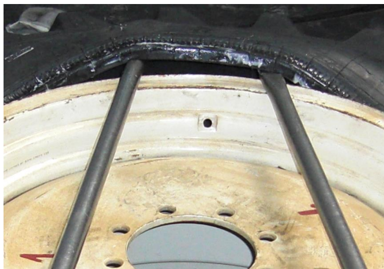
Рис. 18 Извлечение части борта шины за закраину обода.
