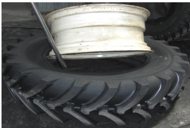
Рис. 10 Ввод монтажной лопатки между бортом покрышки и ободом.
