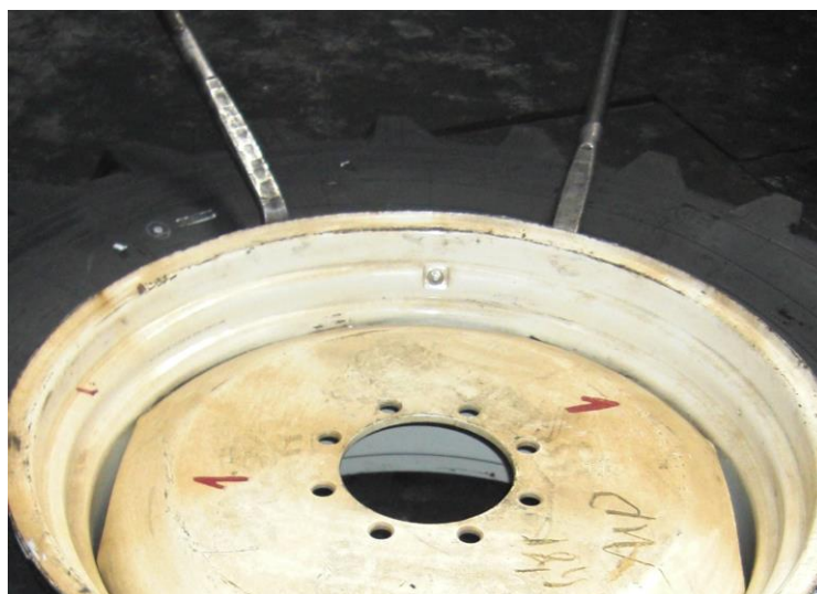
Рис. 15 Окончание заведения борта покрышки за обод.
