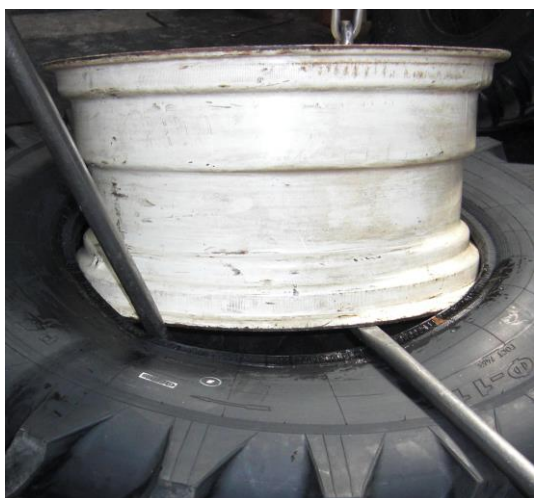
Рис. 21 Ввод монтажной лопатки с изогнутым концом.
