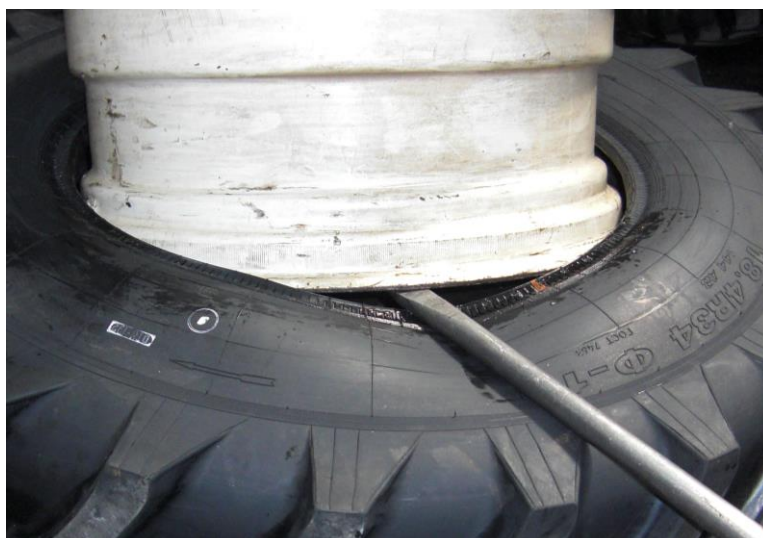
Рис. 20 Подъем обода до упора в борт покрышки.
