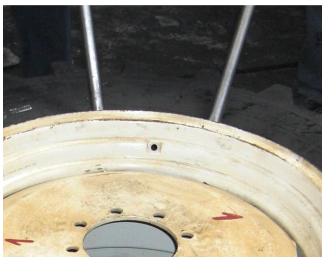
Рис. 17 Демонтаж шины с помощью лопатки.
