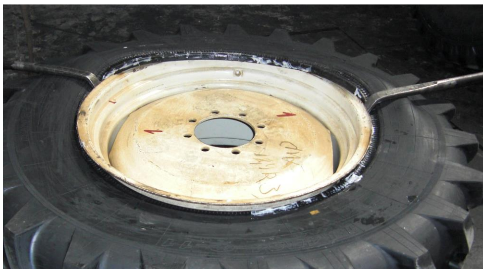
Рис. 14 Процесс монтажа покрышки с помощью лопатки.
