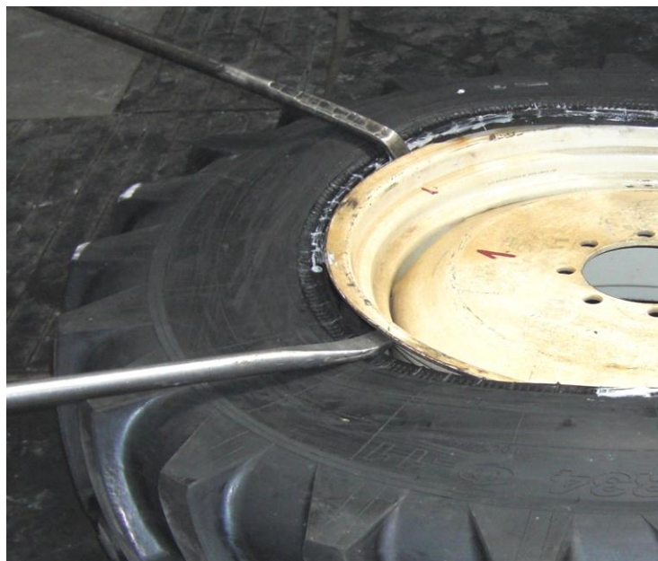
Рис. 13 Начало заведения борта покрышки за обод
