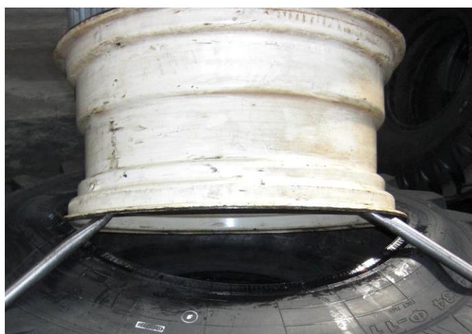
Рис. 22 Освобождение обода от покрышки.
